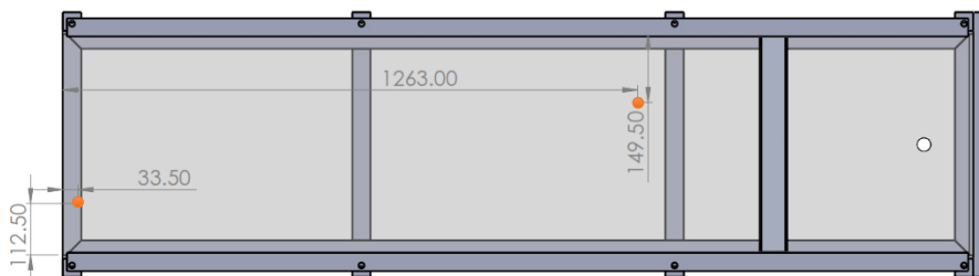
Figura 3.1 Esquema de ubicación de tubos Pitot en el tanque de pruebas
