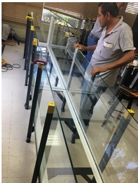
Figura 2.8 Tanque de vidrio templado
