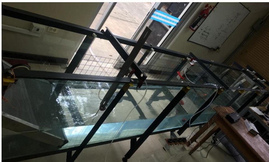
Figura 2.10 Tanque de olas para el Laboratorio de Ingeniería Naval
