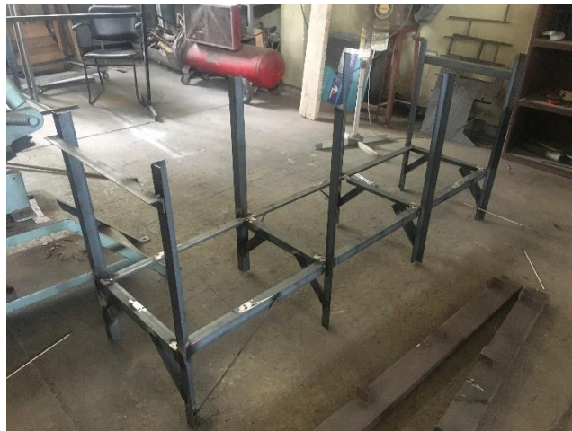
Figura 2.7 Base del tanque
