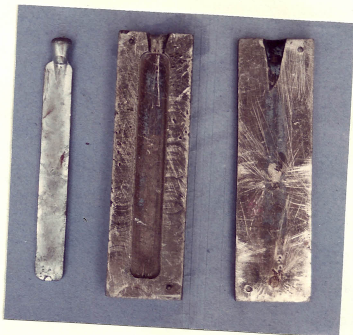
Fig. 1.2 Molde de aluminio y probeta de ZA-27.
