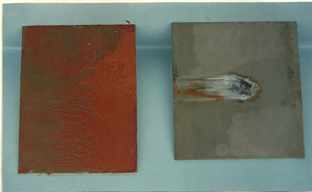
Fig. 2.3 Planchas de acero naval.(40 dias de exposicion) Izq.: sin acople; der.: con acople de ZA-27
