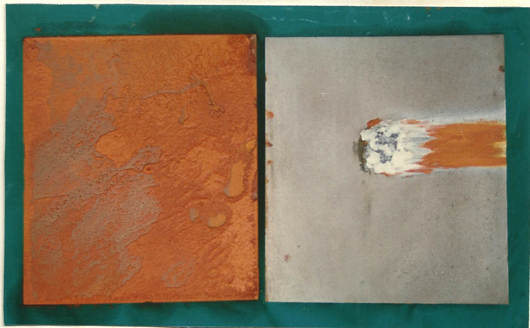
Fig. 2.4 Planchas de acero naval.(60 dias de exposicion) Izq.:sin acople; der.: con acople de ZA-27.
