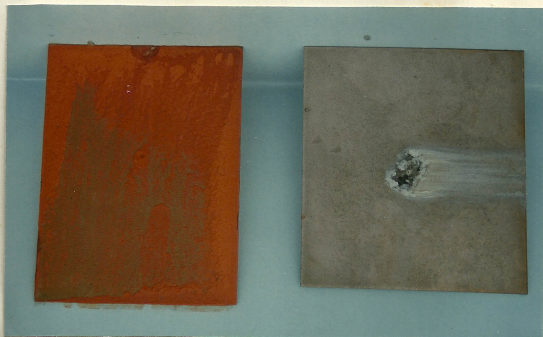
Fig. 2.2 Planchas de acero naval.(30 dias de exposicion) Izq.: sin acople; der.: con acople de ZA-27
