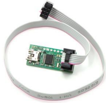
Fig. 2.4.2: Pololu USB AVR Programmer
