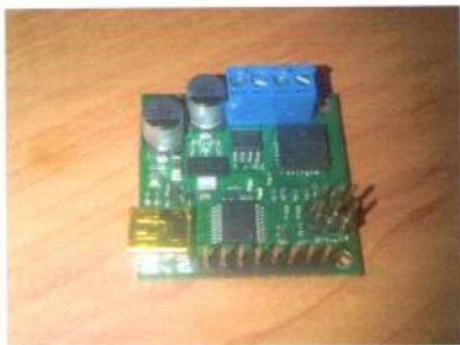
Figura 3.5.3a Tarjeta Pololu JRK 21v3.
