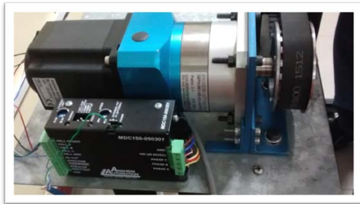
FIGURA 1.46. ENSAMBLAJE DE DRIVER, MOTOR, REDUCTORA Y POLEA CONDUCTORA
