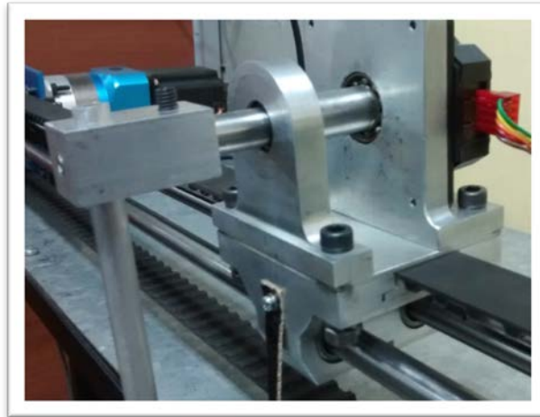
FIGURA 1.47. DETALLE DEL MÓVIL, BANDA, GUÍAS DE DESLIZAMIENTO Y PÉNDULO.
