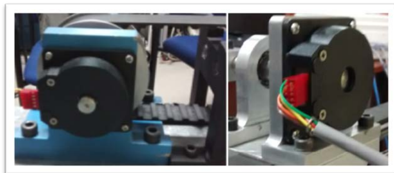
FIGURA 1.50. DETALLE DE ENCODERS INSTALADOS PARA MEDICIÓN DE POSICIÓN LINEAL (IZQ.) Y POSICIÓN ANGULAR (DER.)
