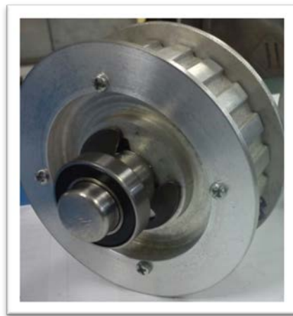
FIGURA 1.37. POLEA CONDUCTIDA, CON EJE Y RODAMIENTOS.
