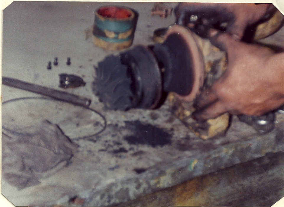
Fig. # 15.-Vista interior del turbo, turbina gases de escape
