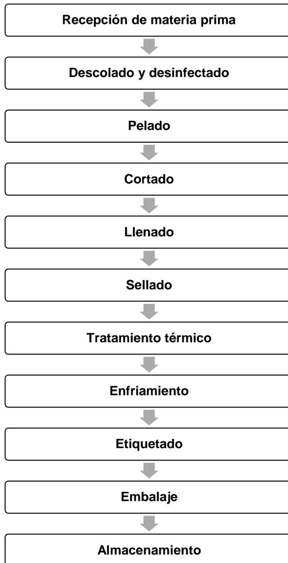
**Figura 3.6 Diagrama de flujo de proceso del producto.**
