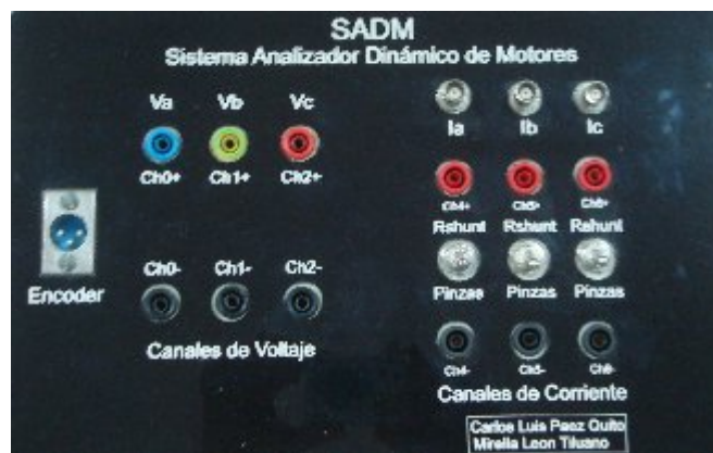
Figura A - 4 Vista del Panel de Conexiones del SADM
