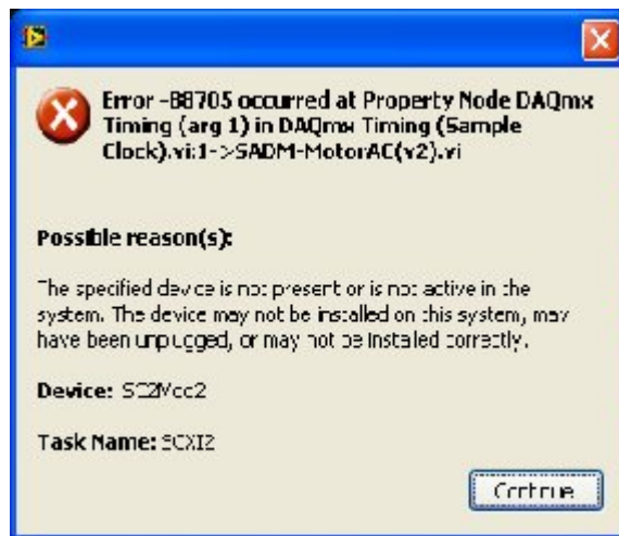
Figura A - 31 Error Mostrado del DAQmx Timing
