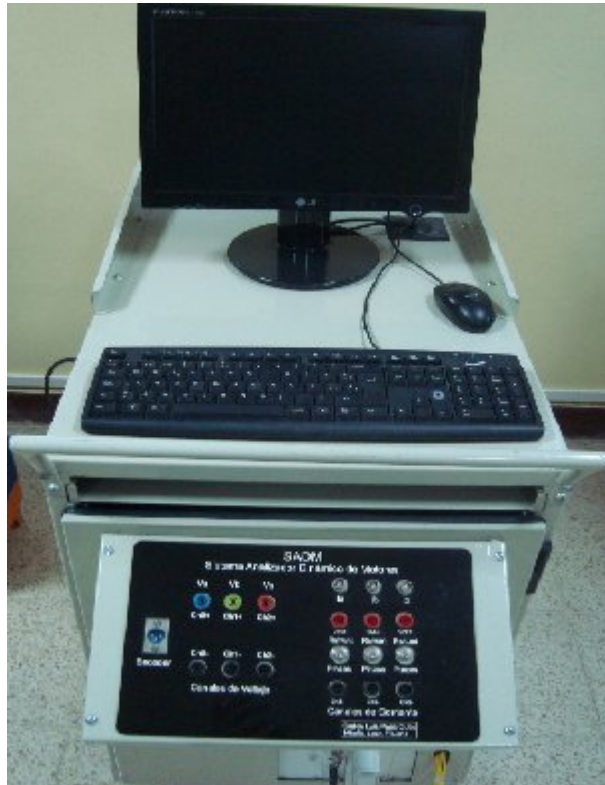
Figura A - 3 Sistema Analizador Dinámico de Motores “SADM”
