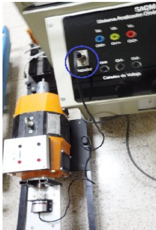
Figura A - 16 Conexión del Encoder con el SADM
