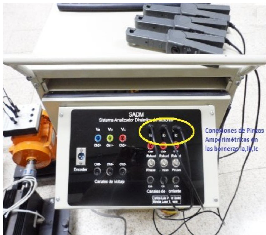
Figura A - 14 Conexión de Pinzas Amperimétricas en el SADM
