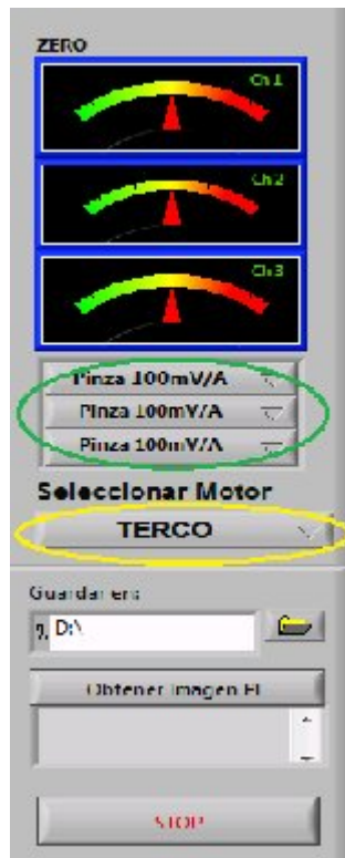
Figura A - 21 Selección de escala para las pinzas amperimétricas y selección del tipo de motor
