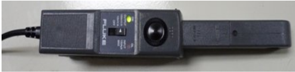
Figura A - 15 Pinza Amperimétrica con escala de 100mV/A
