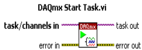
Figura 2.21 Función DAQmx Start Task.
