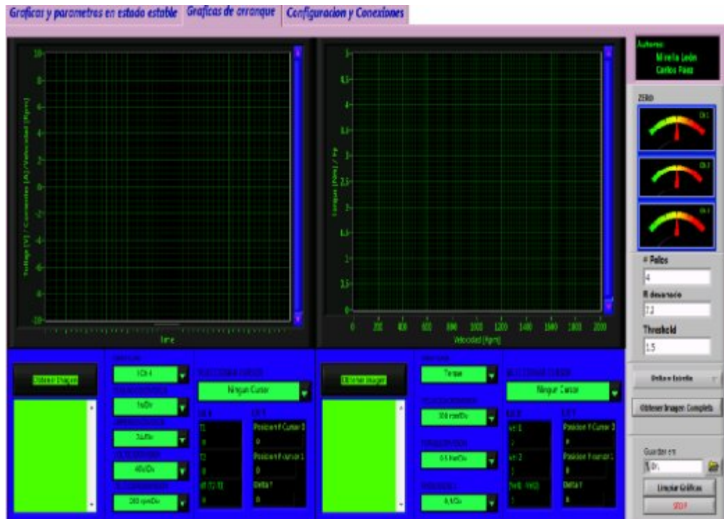
Figura A - 26 Panel Frontal del programa “Analizador AC”: Selección de la pestaña Gráficas de Arranque.
