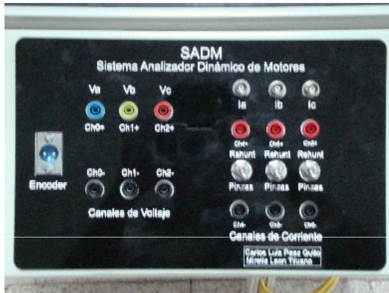
Figura 4.2 Vista del panel donde se realizarán conexiones del SADM.
