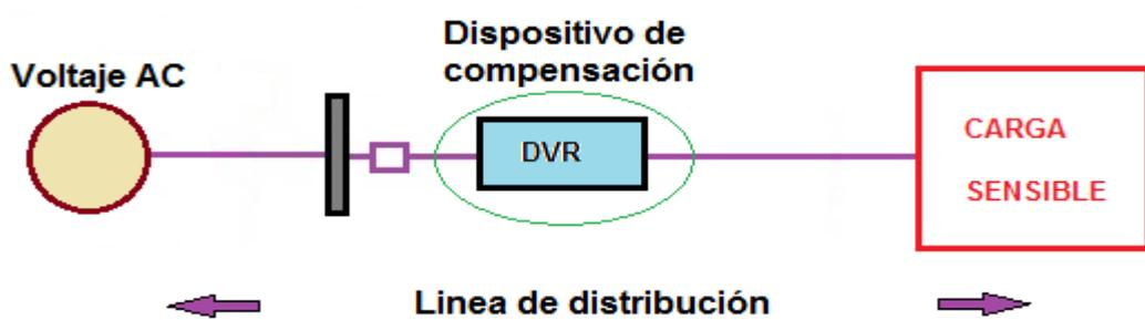
Fig. 1.2. Conexión del DVR en la red.
