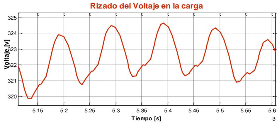
Fig. 3.12. Rizado del voltaje en el capacitor.
