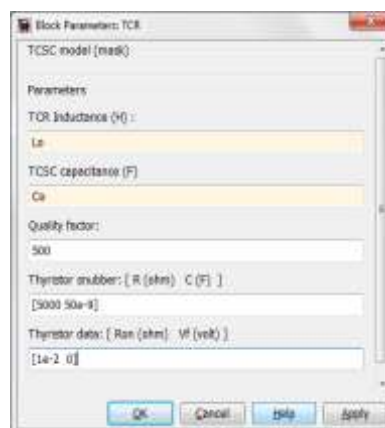
Figura 5.8. Parámetros del bloque del Compensador del TCSC.
