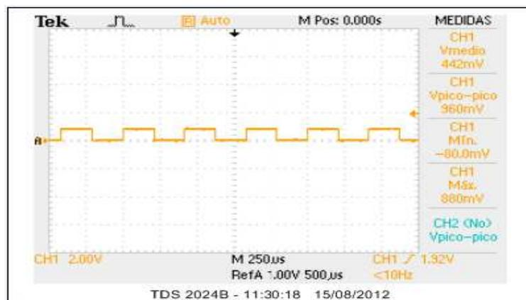
Figura 4.34 Señal en la base del transistor 2N3904
