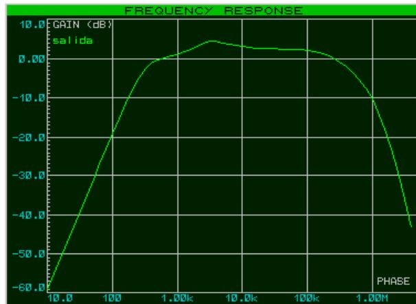
Figura 4.6 Señal del Filtro Pasa Banda 300 Hz – 3KHz
