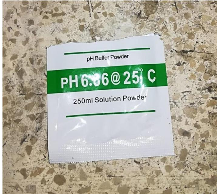
**Figura 0.7 Solución patrón de nivel de pH**
