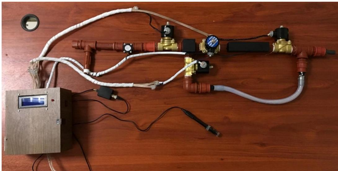
**Figura 0.10 Configuración de sistema de medición de gases**
