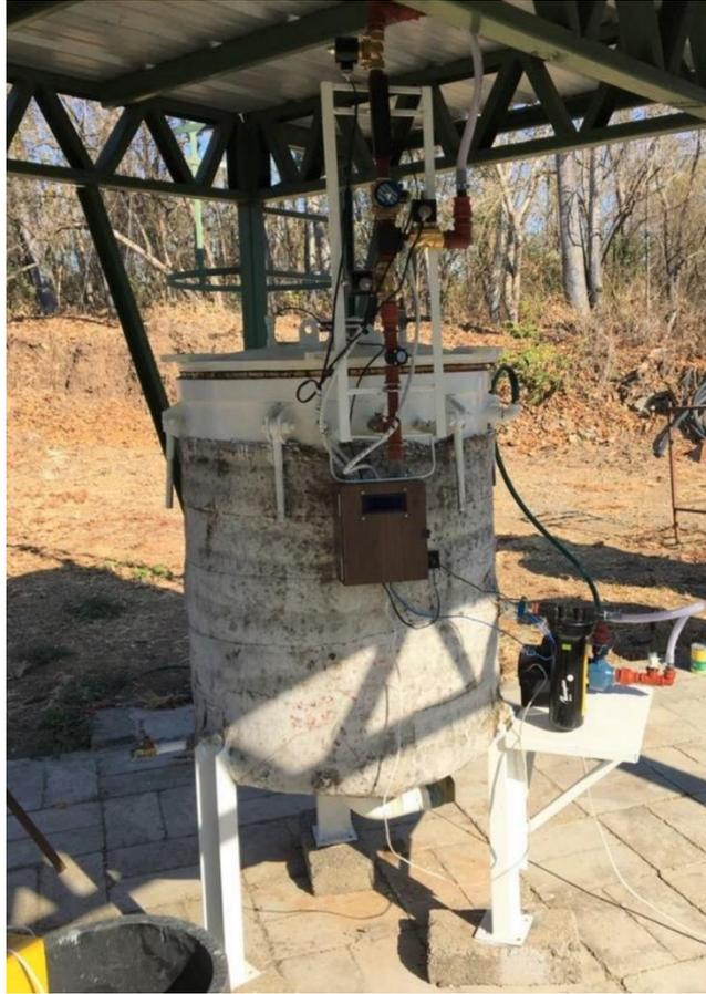
**Figura 0.11 Biodigestor con sistema de control montado**
