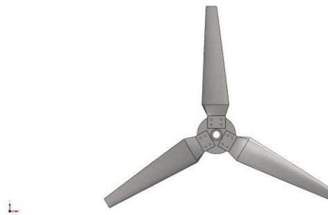
Figura 2.32 Modelo CAD del rotor de turbina
