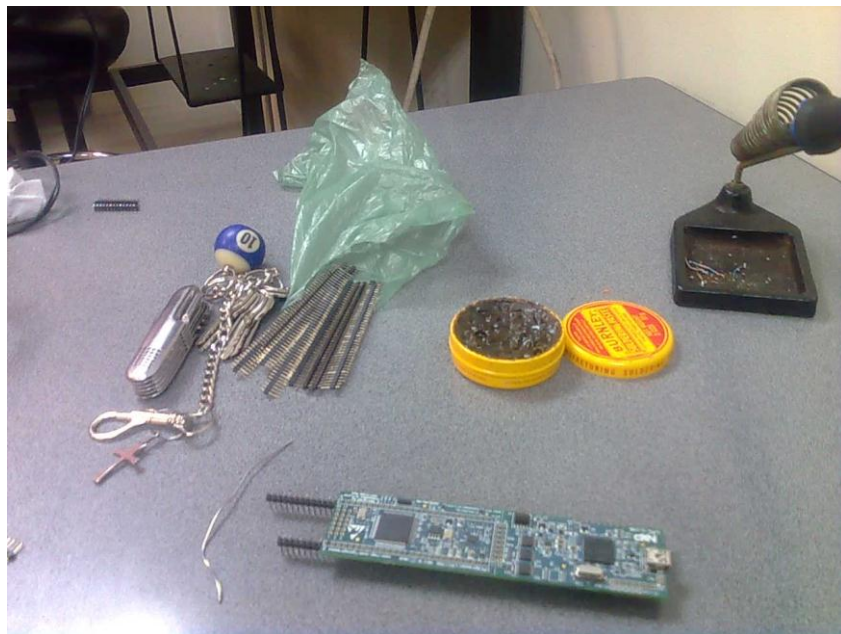
Figura 3.2: Soldando los espadines a la tarjeta
