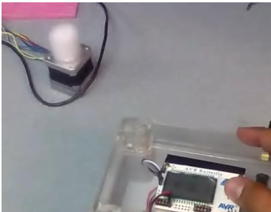
Figura 4.4: Motor BLDC controlado por Joystick de la tarjeta AvrButterfly.
