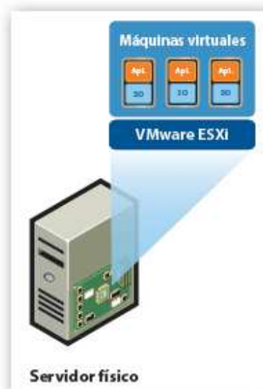
Fig. 2.2 Ejecución de varias aplicaciones sobre ESXi
