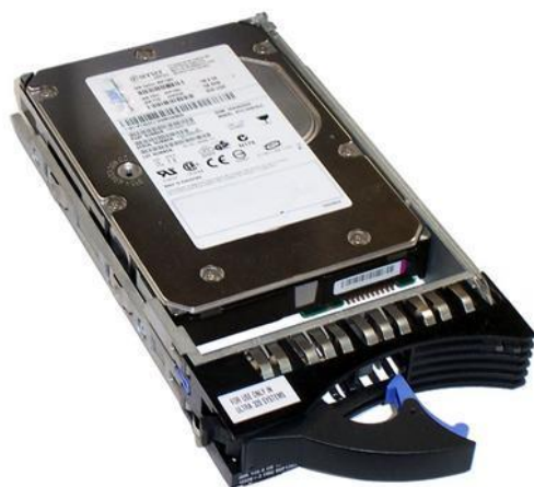
Figura 4.15 Disco duro del arreglo FastT600 removido del rack (tomado de [4])
