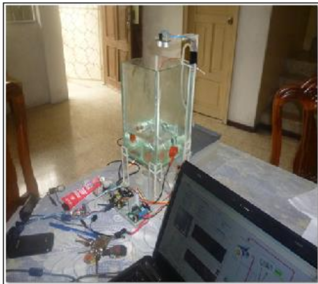
Figura 3.19 Montaje de la Planta
