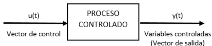
Figura 2.1 Diagrama de bloques de la dinámica de un proceso lineal [28]
