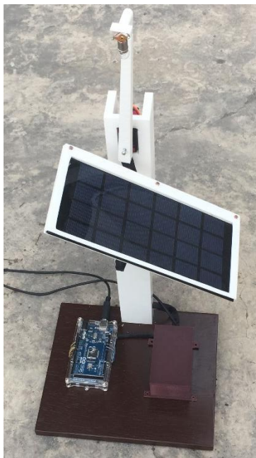
Figura 4.26 Prototipo de captación de energía solar en modo seguidor de la posición del sol
