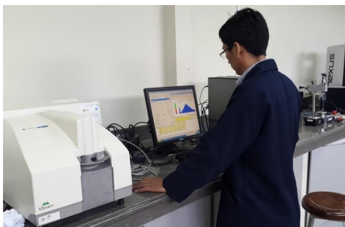
Figura 3.1: Prueba realizada en el MasterSizer
