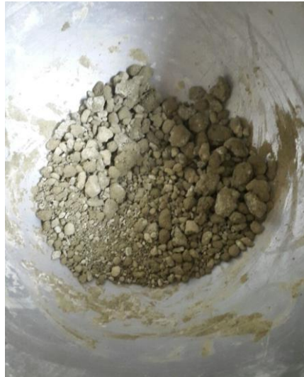
Figura 3.6: Mezcla N°1 con mala trabajabilidad.
