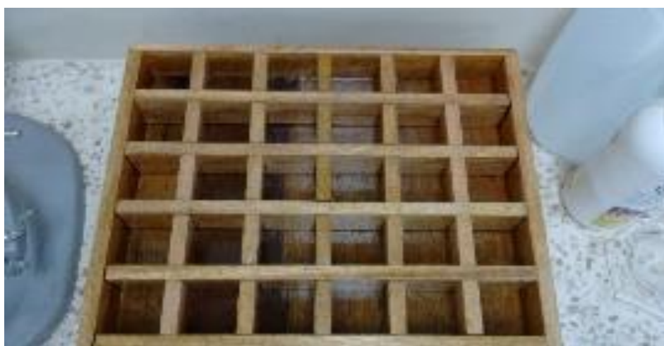
Figura 3.5 : Moldes de madera según especificaciones al estándar ASTM C109/C109 M
