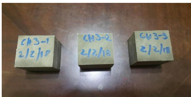
Figura 3. 7 Cubos de Cemento Híbrido
