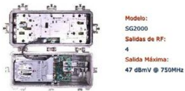
Figura 2.6 Nodo óptico Motorola SG2000
