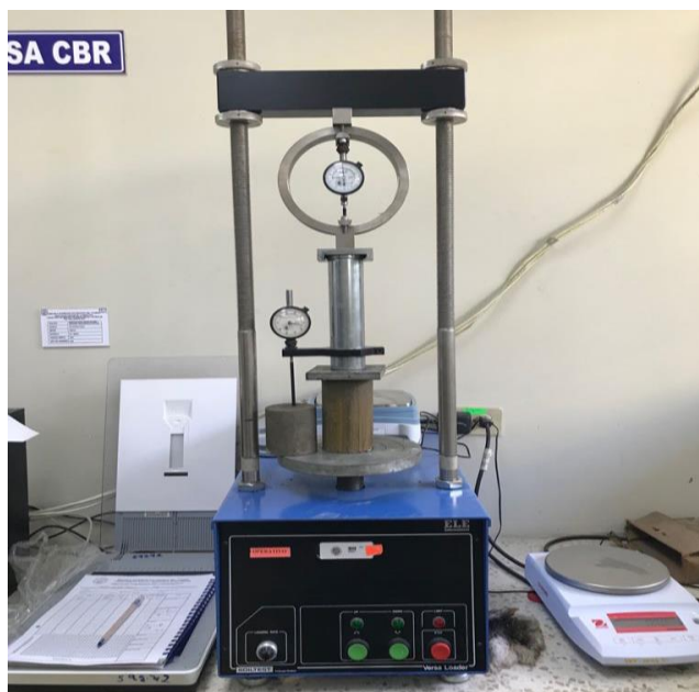
Figura 3.8 Ensayo de compresión Simple.
