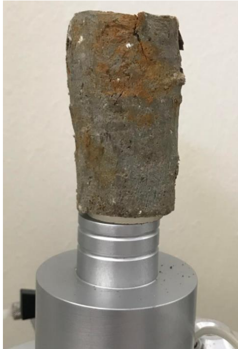
Figura 3.11 Falla del espécimen. Fuente: León, D., Valdivieso, V., 2018.
