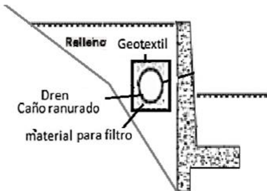
Figura 3. 17 Dren para captar las aguas subterráneas. Fuente: Suárez, C., Vicuña, B., 2018.
