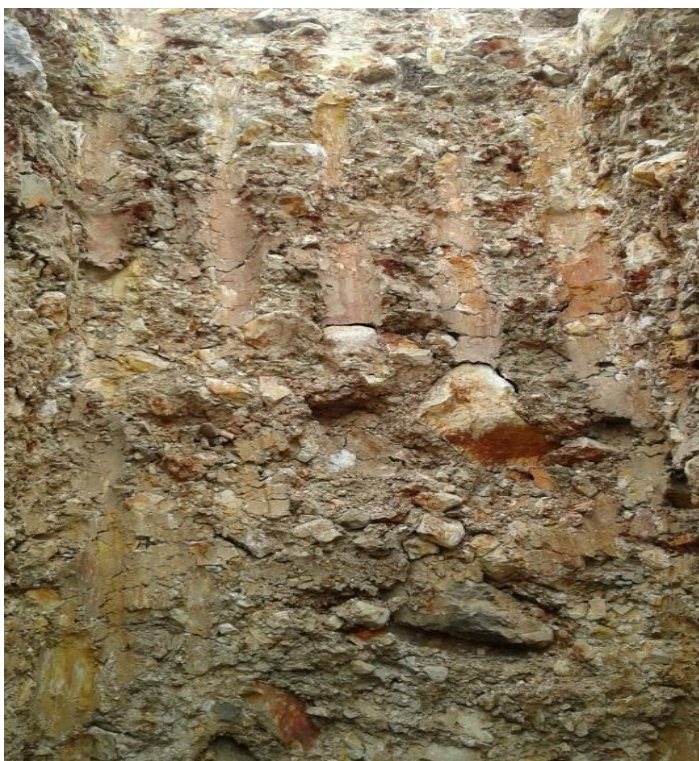
Figura 3. 8 Calicata realizada en terreno. Fuente: Suárez, C., Vicuña, B.,2018.
