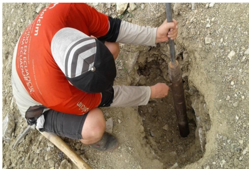
Figura 3. 10 Proceso para obtener una muestra inalterada Fuente: Suárez, C., Vicuña, B.,2018..
