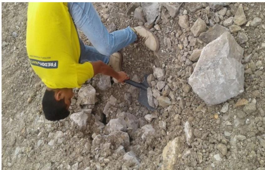
Figura 3. 9 Proceso para realizar calicata de 1m. Fuente: Suárez, C., Vicuña, B.,2018.
