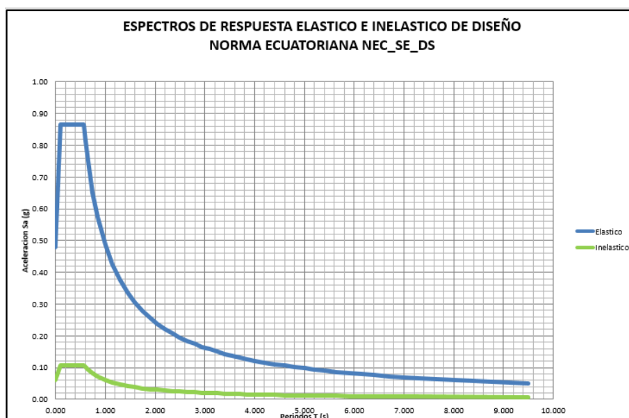
Figura 6. 1 Espectro elástico e inelástico de respuesta sísmica según NEC 2015 del sistema aporticado con muros de corte.
