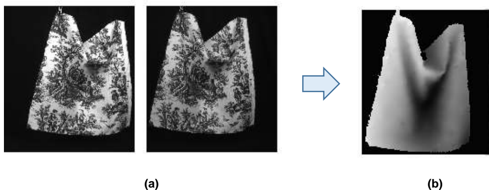
Figura 3.6. Ejemplo. En (a) se encuentra un ejemplo de dos imágenes VS del mismo plano. (b) es el resultado del mapa de disparidad obtenido
