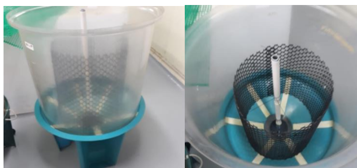
Figura 2. 8 Diseño de la cámara respirométrica
