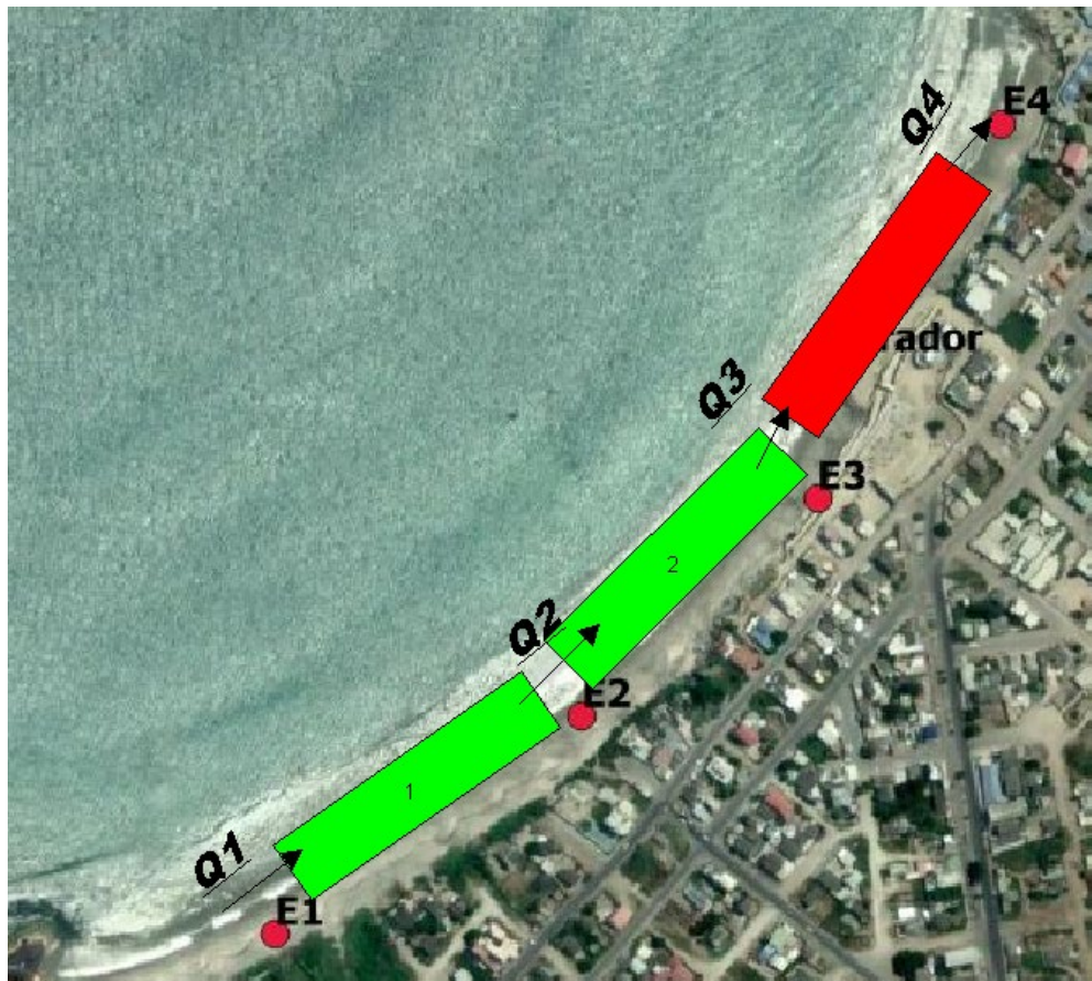
Ilustración 56.- Representación de procesos erosivos/acrecivos con Qs estimados por (Sanchez, 2011b) mediante el modelo SBAS
