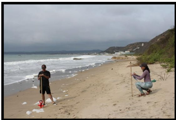
Figura 2.6. Toma de perfil de playa con el método de Emery. (Autores, 2019)
