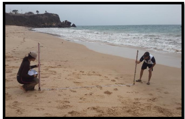
Figura 2.7. Toma del perfil de playa con el método Andrade. (Autores, 2019)
