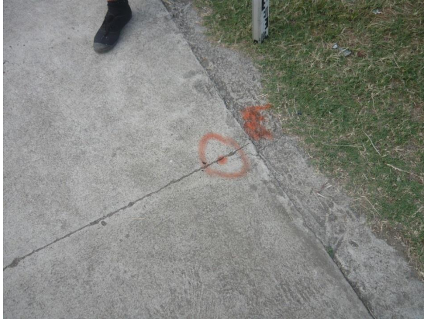
Figura 11.9 BM arbitrario para obtención de cotas
