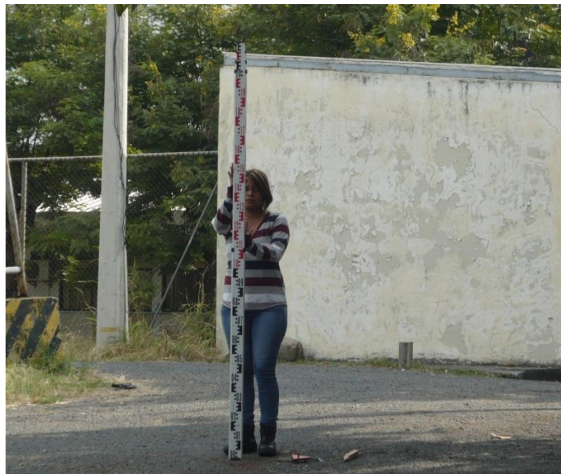
Figura 11.10 Medición del BM Base
