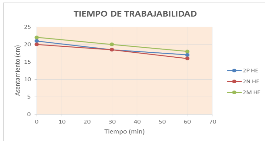
Figura 3.11 Tiempo de trabajabilidad de la dosificación 2 HE (Arellano & Fierro, 2018)
