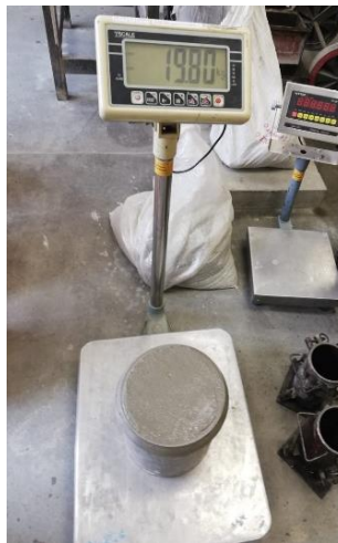
Figura 2.6 Densidad del Concreto fresco (Arellano & Fierro, 2018)
