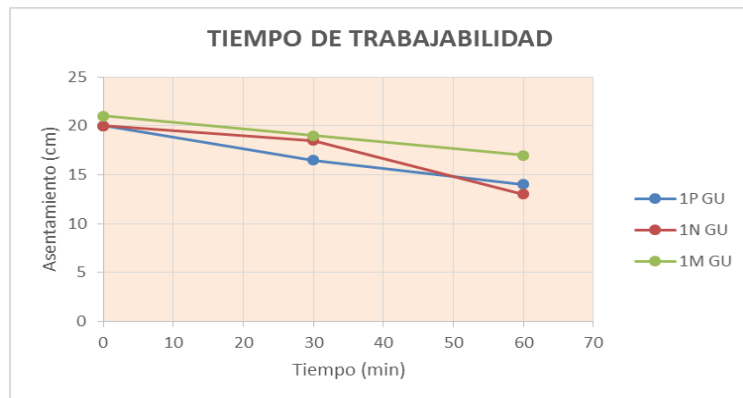
Figura 3.13 Tiempo de trabajabilidad de las dosificaciones 1 GU (Arellano & Fierro, 2018)
