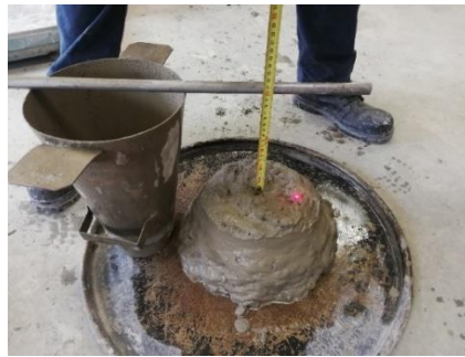
Figura 2.6 Ensayo de Asentamiento (Arellano & Fierro, 2018)
