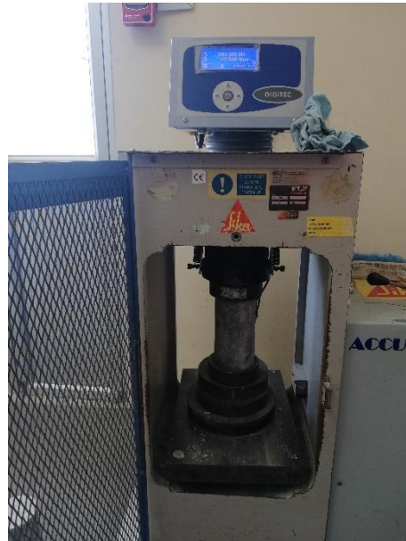
Figura 2.9 Rotura de Cilindros de Hormigón (Arellano & Fierro, 2018)
