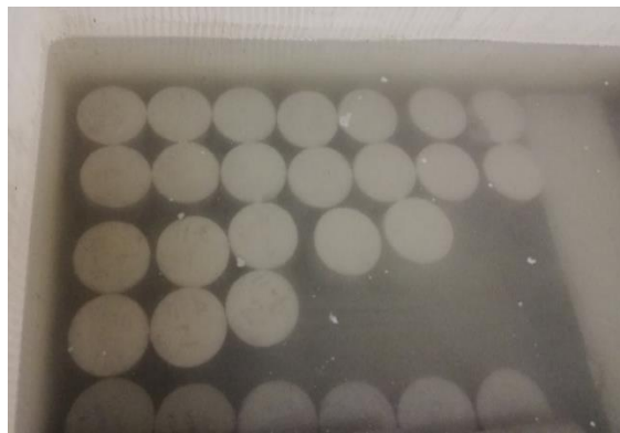
Figura 2.10 Curado de Cilindros de hormigón (Arellano & Fierro, 2018)
