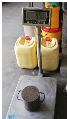
Figura 2.4 Ensayo de densidad (Arellano & Fierro, 2018)
