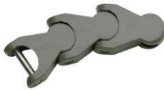
La cadena uni 1701 se suministra con una inclinación lateral de 8°. Esto hace posible diseñar curvas que sujeten la cadena mientras trabaja y al mismo tiempo que la cadena pueda separarse fácilmente del tramo curvo para su limpieza. La cadena es idónea para transporte de botellas de plástico, latas y cartones p.ej. en centrales lecheras y cerveceras.
