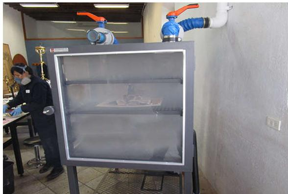
**Figura 2.3 Cámara de fumigación por termonebulización (Marco Polo Alta tecnología en preservación, 2018)**
