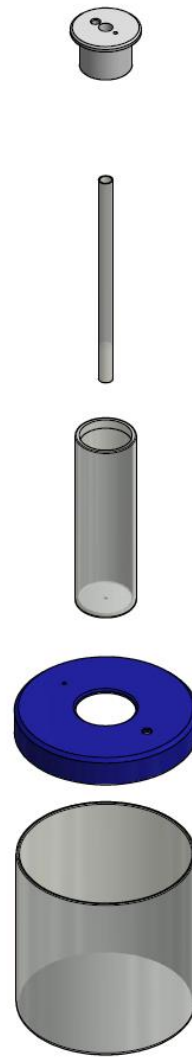
Figura 3.12 Explosión en 3D del oxigenador de burbuja
