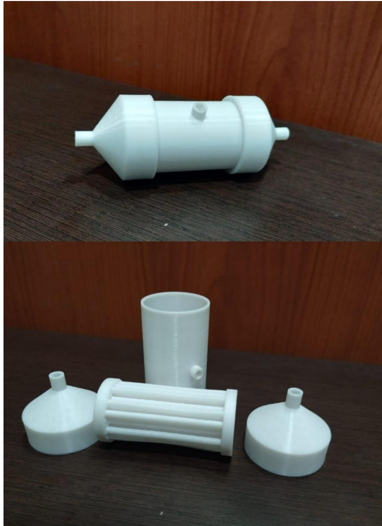
Figura 3.20 Oxigenador de membrana por impresión 3D
