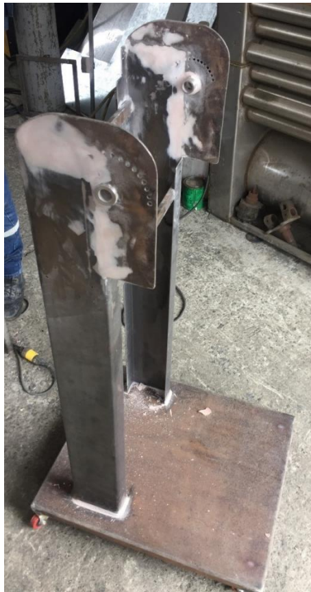
Figura C8. Corrección de uniformidades en el metal
