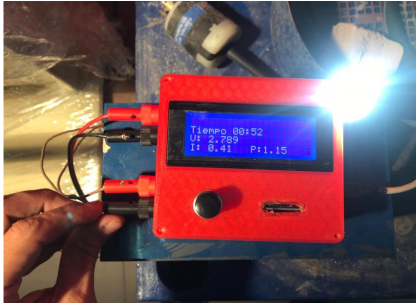
Figura C31. Prueba de funcionamiento con la carga conectada.
