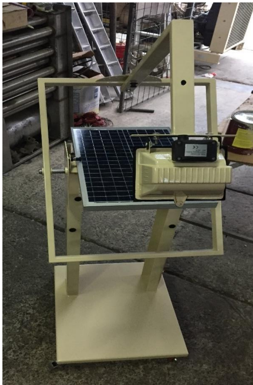
Figura C16. Instalación del panel y de topes de goma para el marco y panel.
