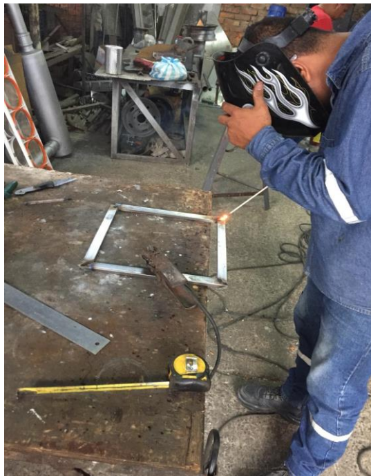
Figura C2. Soldadura de perfiles para crear el marco principal
