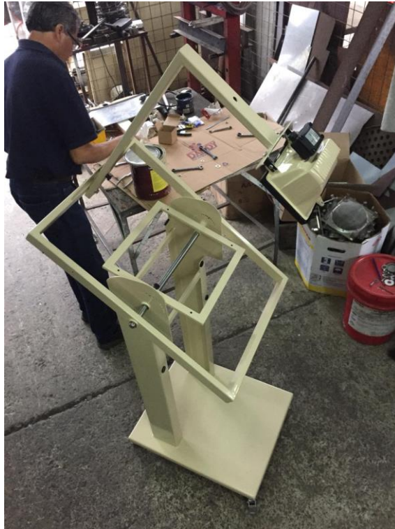
Figura C15. Ensamble del equipo posterior al tiempo de secado de la pintura.
