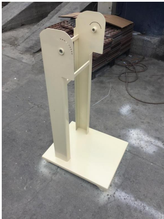
Figura C14. Desmontaje y aplicación de pintura al horno
