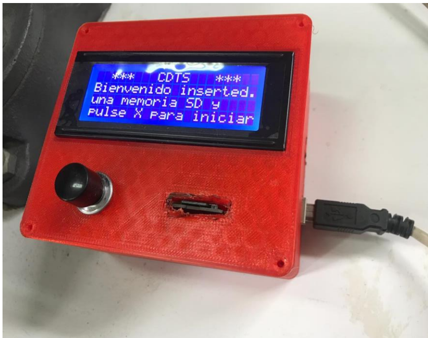
Figura C28. Primer encendido del sistema electrónico con alimentación USB.
