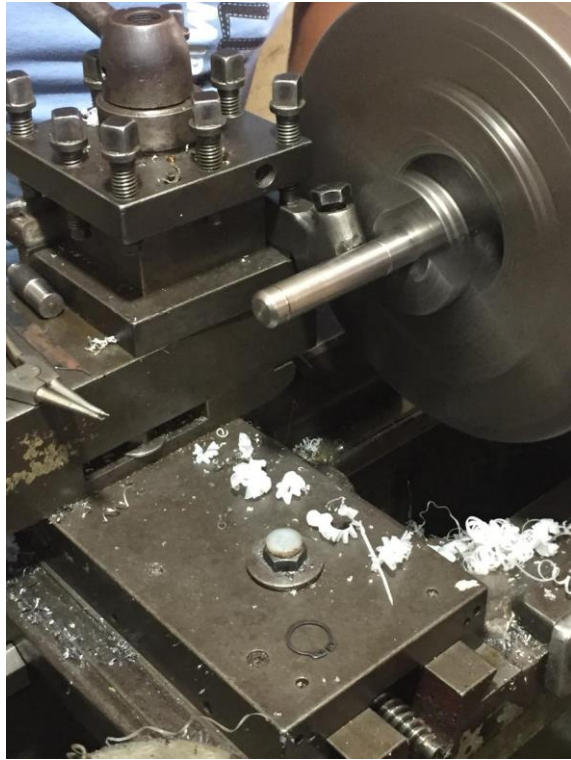
Figura C5. Maquinado del eje de acero inoxidable
