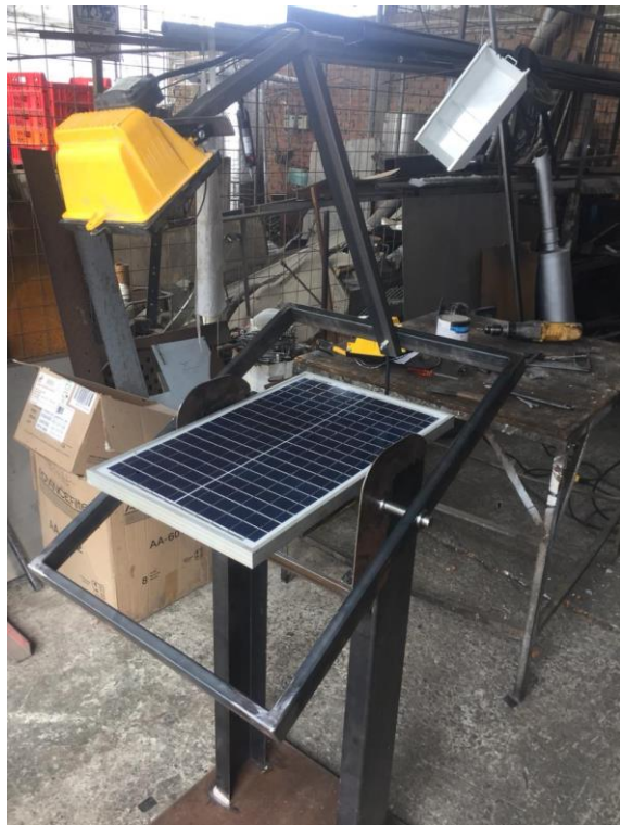
Figura C12. Colocación del reflector al sistema y ajustes varios.
