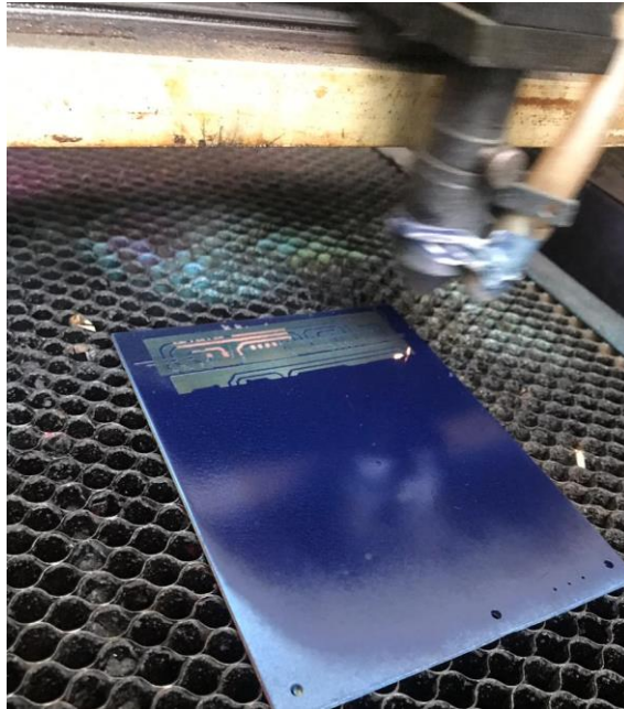
Figura C23. Grabado en laser de la placa del circuito.
