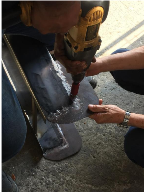
Figura C9. Perforación del acero para los agujeros guía.
