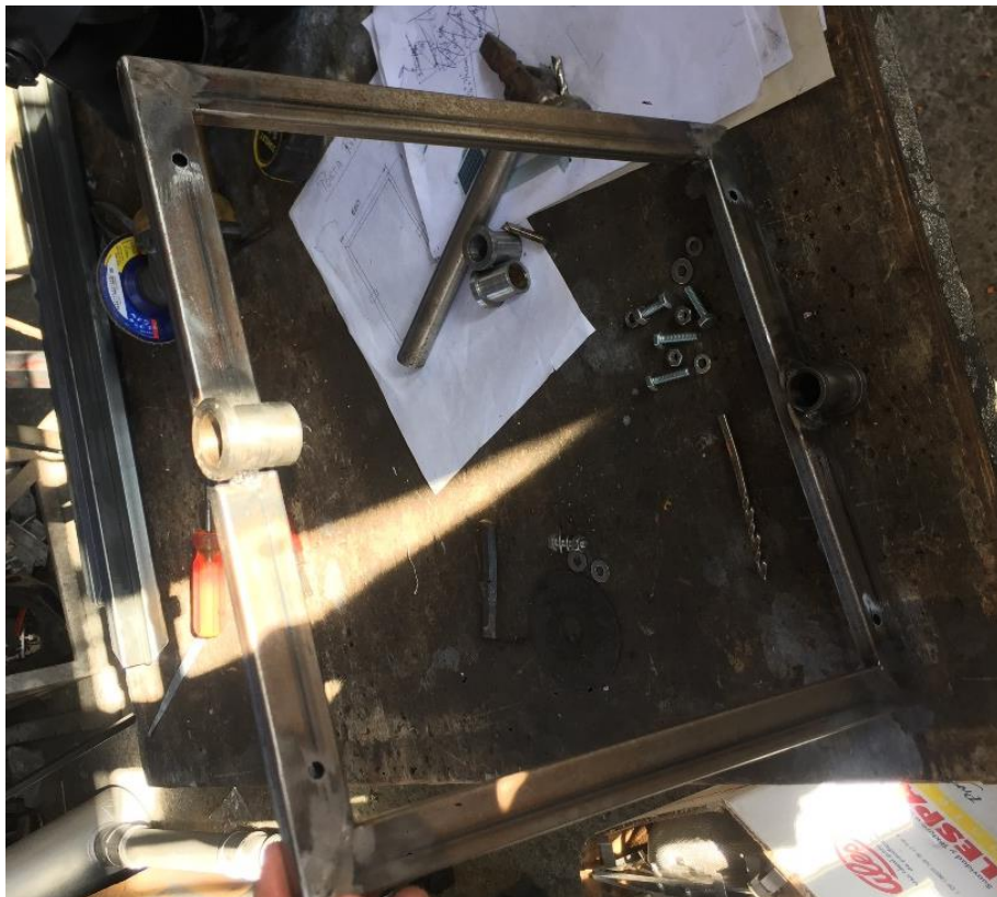
Figura C4. Fijación de los cojinetes en el marco
