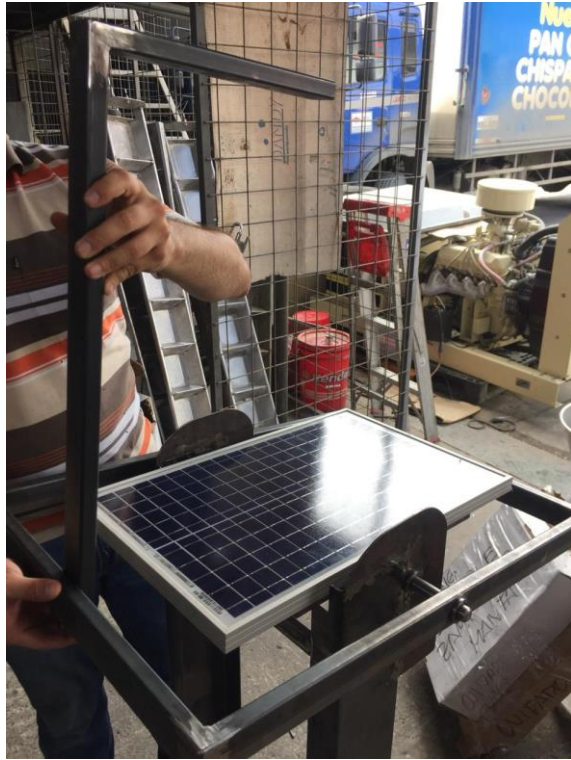
Figura C11. Colocación del brazo del reflector al marco.
