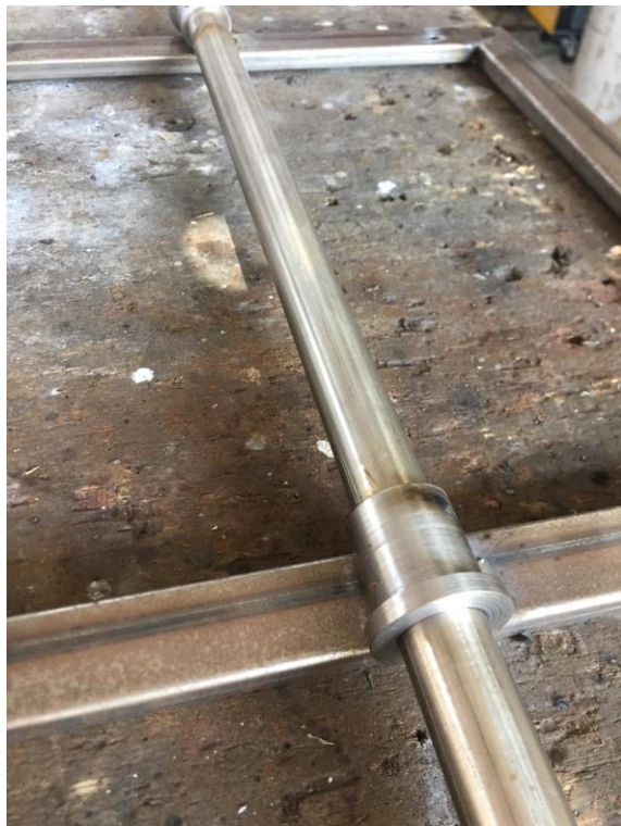
Figura C6. Colocación del eje dentro de los cojinetes al marco.
