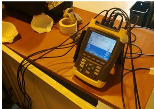
Figura 2. 10. Equipo medidor de calidad de energía Fluke 435.
