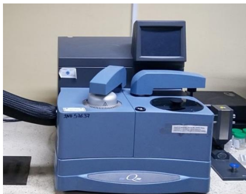
Figura 2. 3 Calorímetro Diferencial de Barrido, marca TA Instruments, modelo Q200
