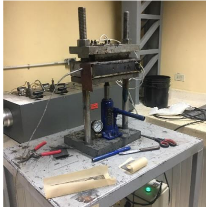
Figura 2. 11. Prensa Térmica Hidráulica Fuente: Laboratorio de Plásticos de la FIMCP
