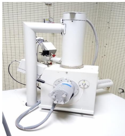
Figura 2. 12. Microscopio electrónico de barrido (MEB) marca Thermo Fisher Scientific, modelo Inspect S
