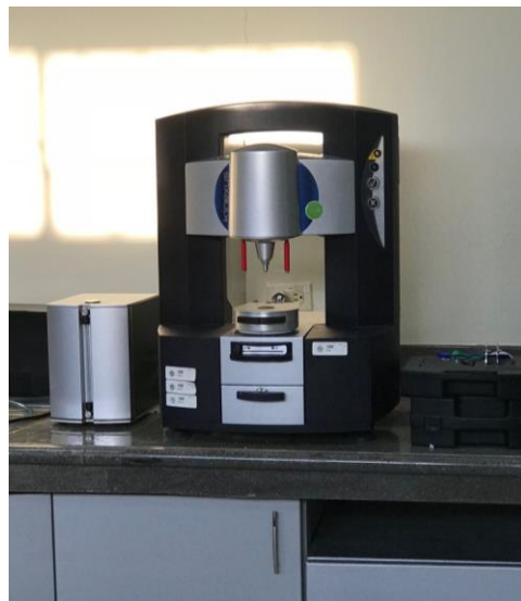
Figura 2. 13. Reómetro rotacional de marca Malver, modelo Kinexus Pro
