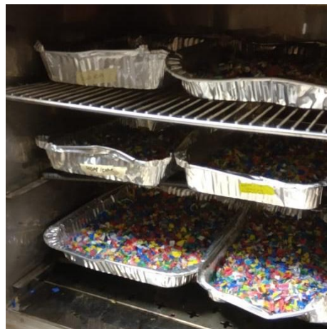
Figura 2. 6. Proceso de secado en recipientes de aluminio Fuente: Laboratorio de Plásticos de la FIMCP
