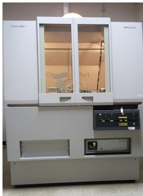
Figura 2. 14. Difractómetro de rayos X, marca PAN Analytical modelo Xpert-PRO
