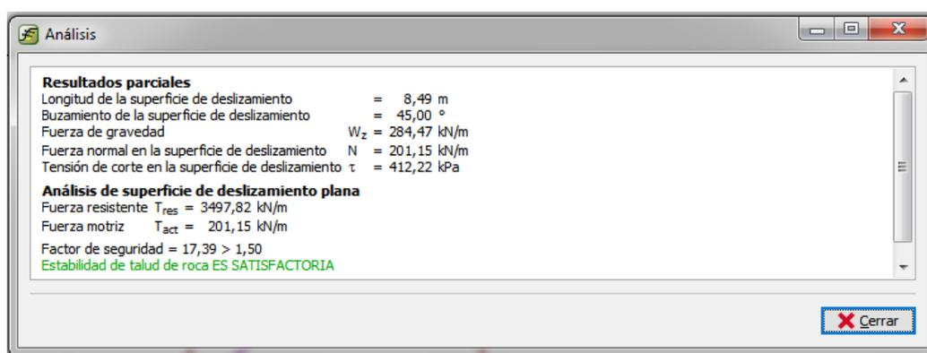
**Figura 0.16** Resultado del análisis de talud de Lutita
