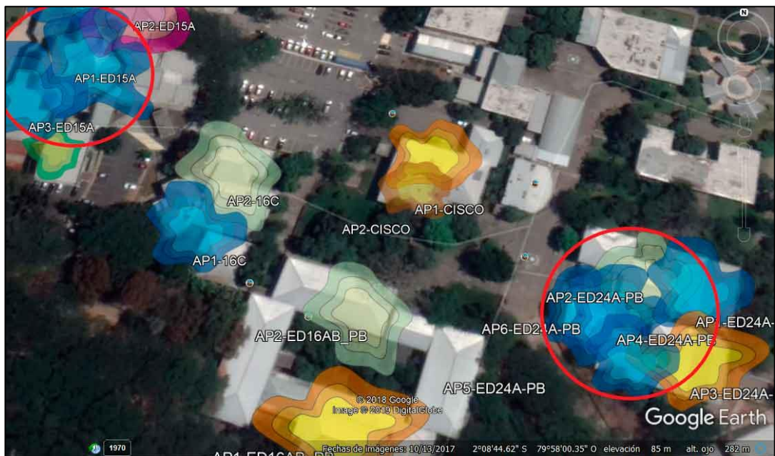
Figura 3.55 Solapamiento de canales entre AP's
