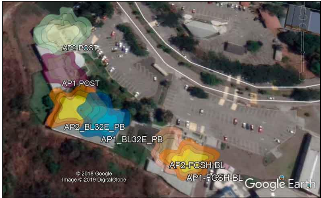
Figura 3.18 Cobertura de los AP's en Postgrado y Bloque 32-E
