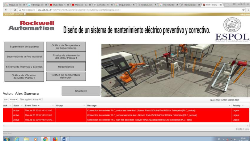
Figura 15. Vista del SCADA desde la web
