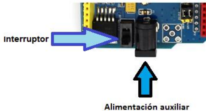
Figura 3.10 Puerto para conexión auxiliar del módulo SIM900 (Autoría propia)
