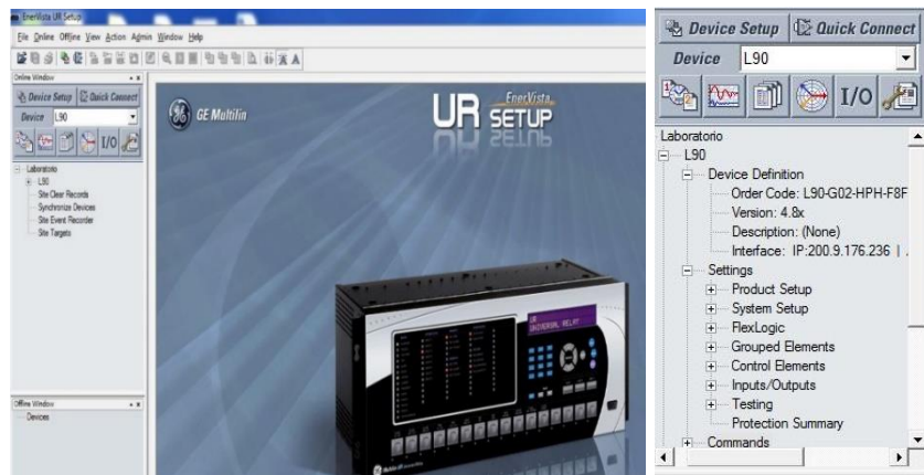
Figura 2.11 Comunicación relé L90 con software Enervista Setup
