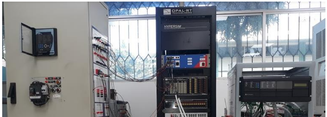
Figura 3.12 Conexión de relés de protección en paralelo
