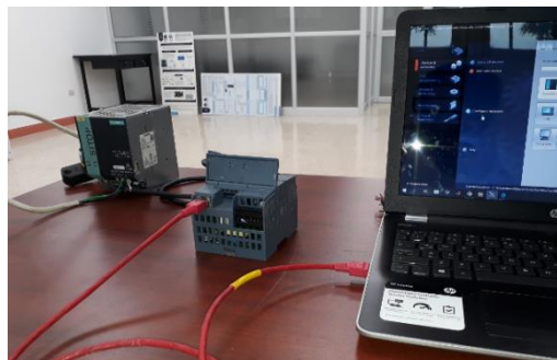
Figura 2.8 Configuración del PLC mediante el software TIA Portal
