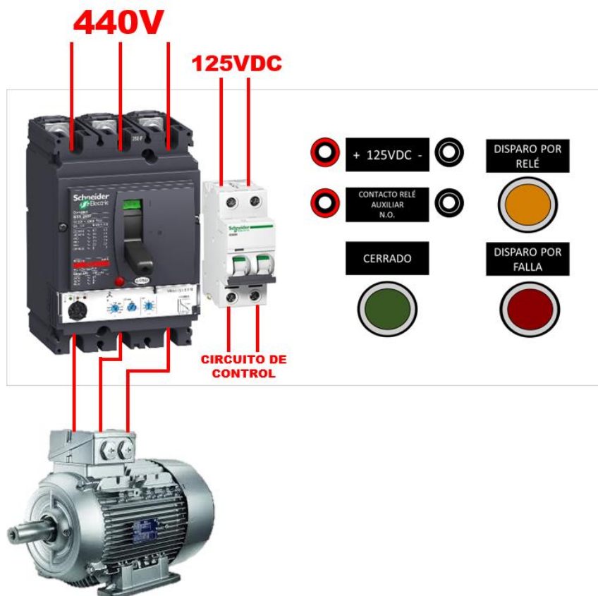
Figura 3.17 Arrancador del motor trifásico
