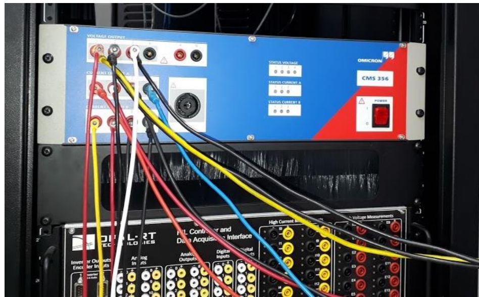
Figura 3.8 Salidas de corriente y voltaje del amplificador CMS 356
