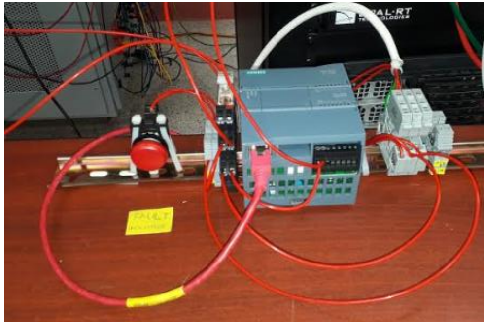
Figura 3.19 Circuito de control para el retorno de señal al simulador
