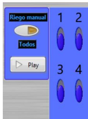
Figura 3.20: Botoneras de Secciones de electroválvulas.
