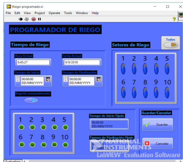
Figura 3.7: Ventana Programador de Riego.
