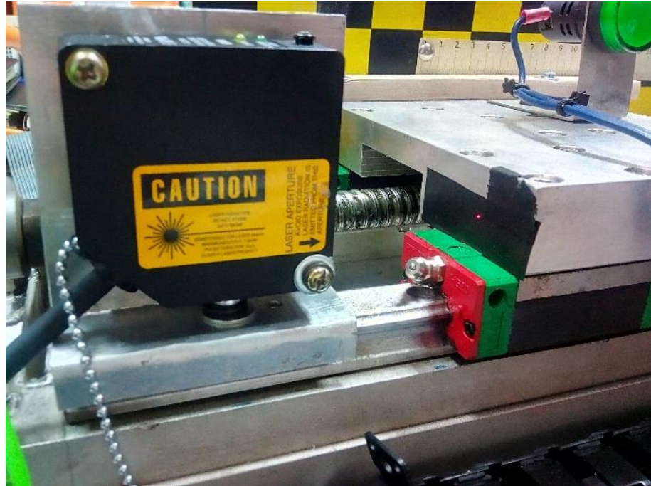
Figura 2.14 Sensor láser instalado
