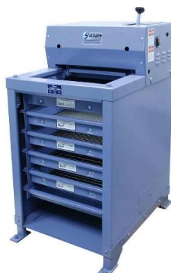
Figura G.3 Harnero vibratorio Gilson TS-1F Fuente: Manual del operador Gilson Testing Screens
