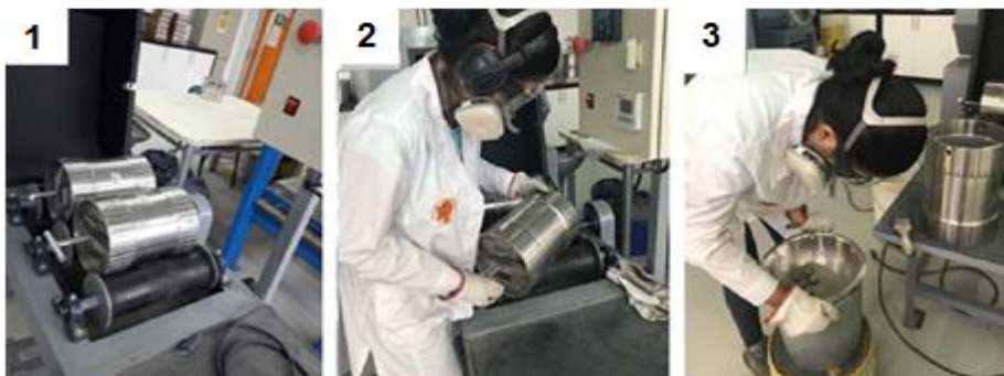
Figura 3.5 Reducción del tamaño de partículas del mineral recibido empleando el molino de bolas.
