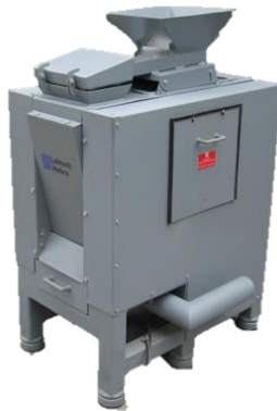
Figura G.1 Trituradora de mandíbula Labtech Hebro. Fuente: Catálogo de productos Labtech Hebro Ltda
