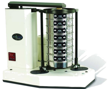
Figura G.4 Dura Tap Advantech DT 258 y tamices Gilson de 8" Fuente: Advantech Manufacturing
