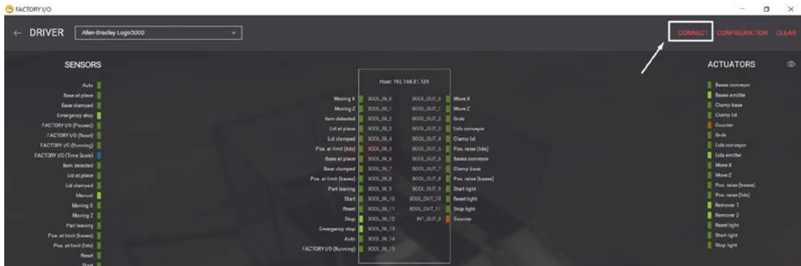
Figura 68 Comunicación del PLC con Factory I/O
