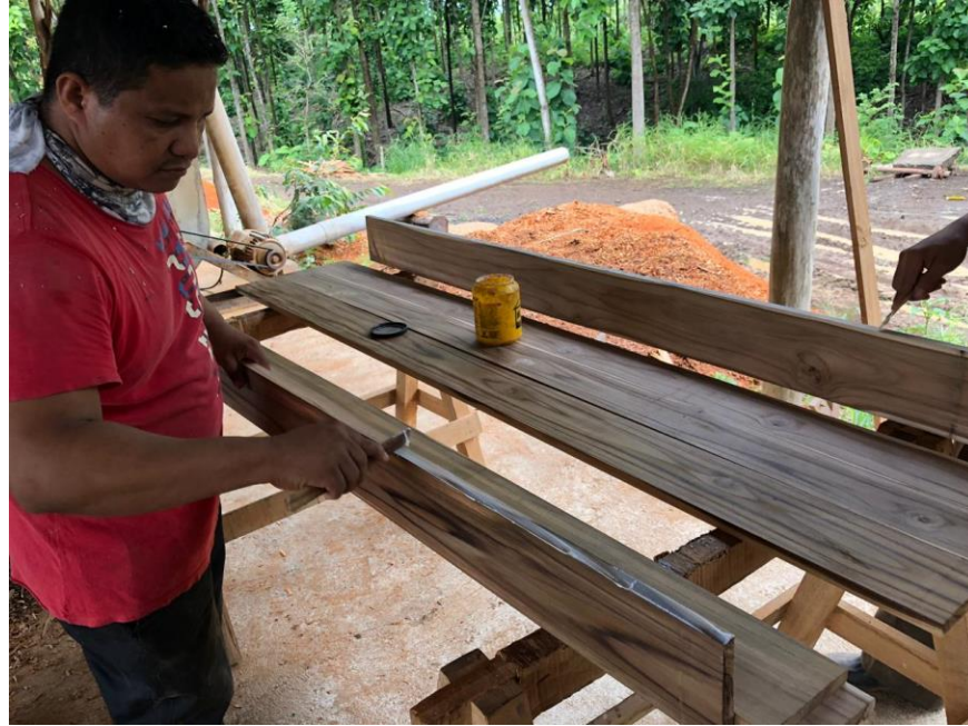
Ilustración 3-7. Ensamblado y pegado de listones de madera
