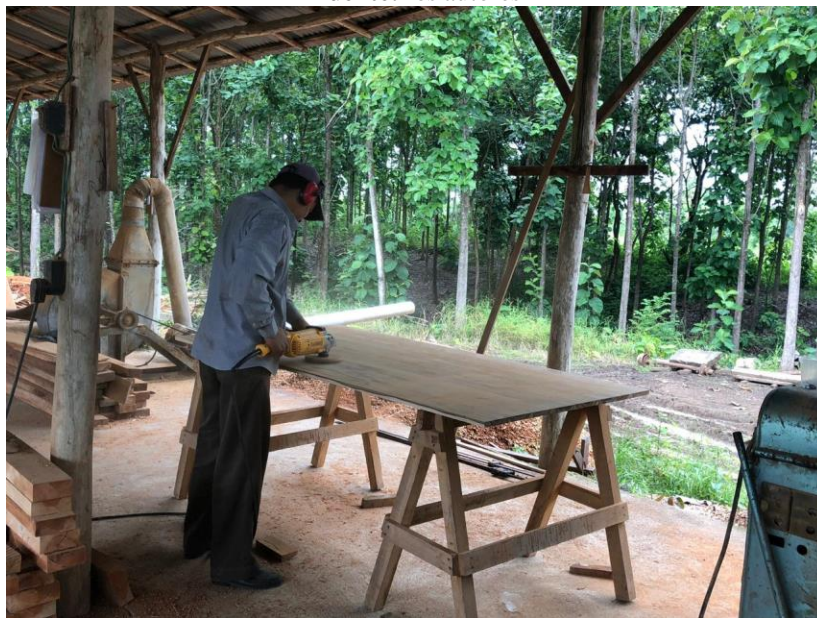
Ilustración 3-10. Pulido de tableros de listones de madera
