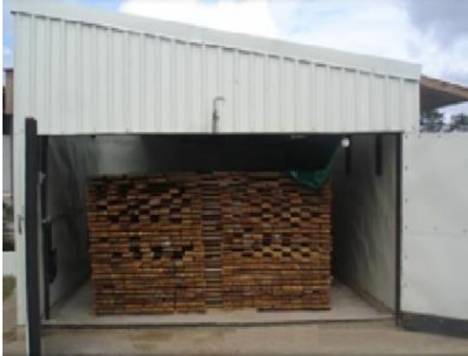
Ilustración 3-5. Listones de madera en horno de secado
