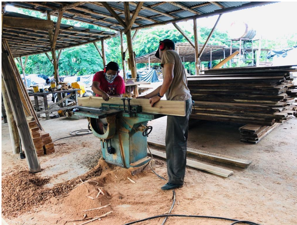
Ilustración 3-6. Canteado y cepillado de tablonces de madera
