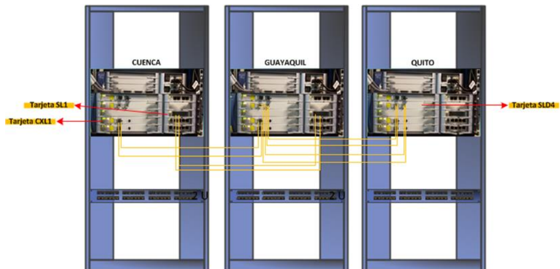
Figura 2. Conexión física de equipos OSN
