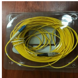
Figura 3. Cable de fibra monomodo LC-FC
