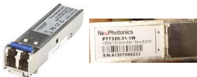
Figura 2.6 Módulos SFP 1310nm.
