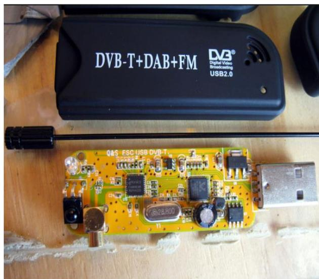
Figura 1.2 RTL-SDR sin carcasa [6]
