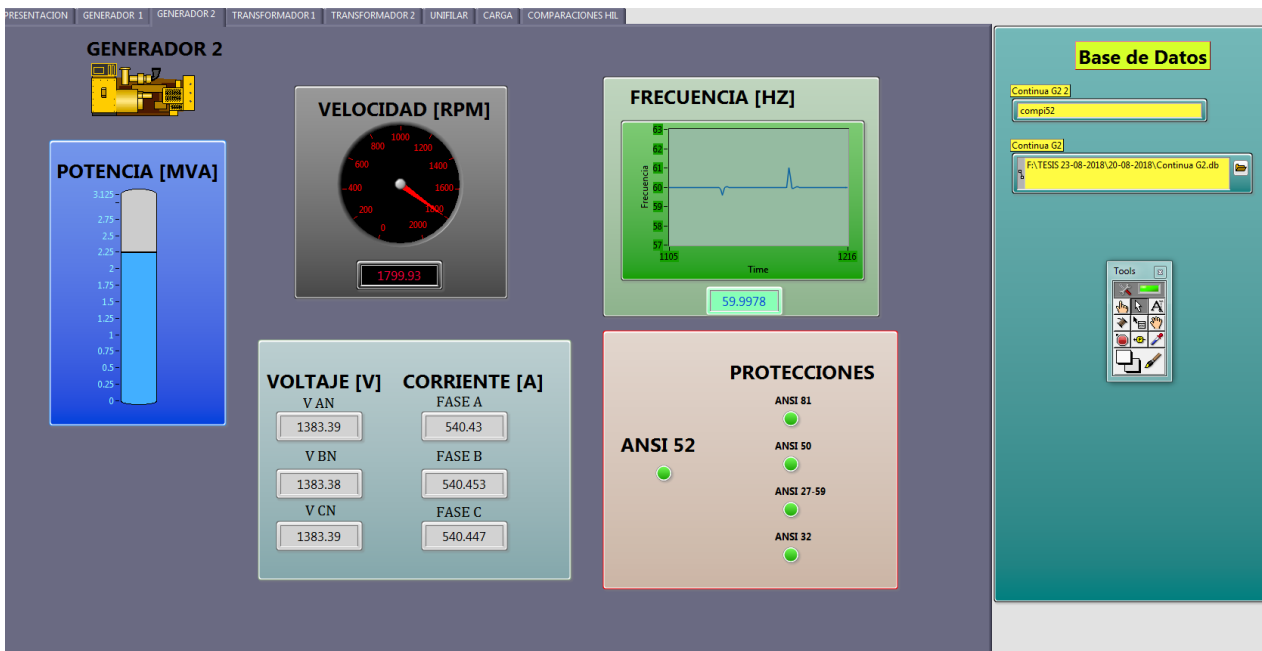
Figura 2.21 Ventana GENERADOR 2 del sistema SCADA.
