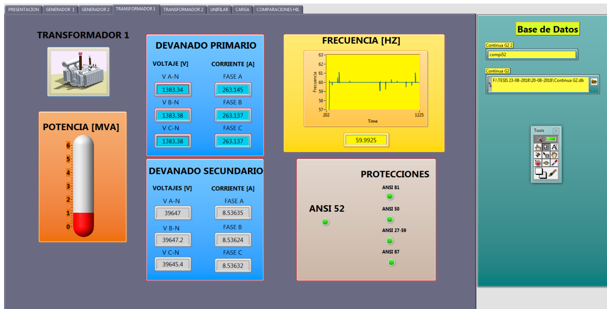
Figura 2.22 Ventana TRANSFORMADOR 1 del sistema SCADA.
