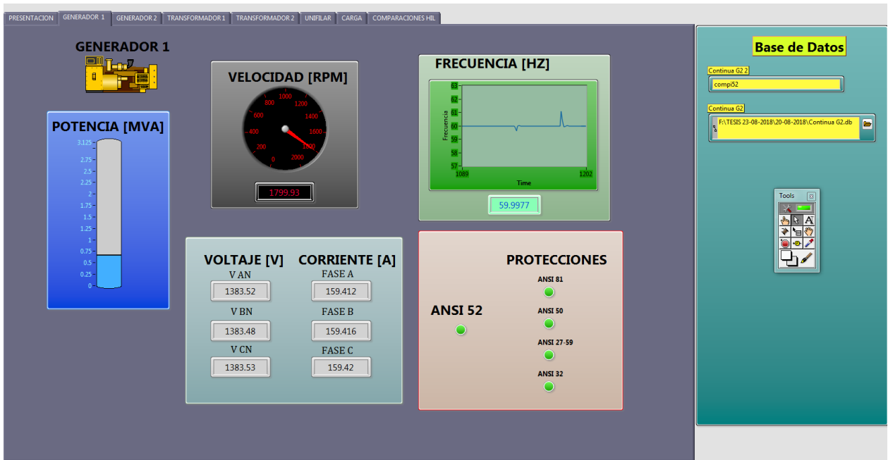
Figura 2.20 Ventana GENERADOR 1 del sistema SCADA.
