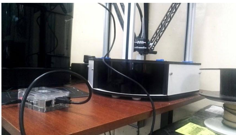
Figura 3.16. Raspberry pi3 e impresora 3D, con cable USB A/B de impresora Fuente: Elaboración propia
