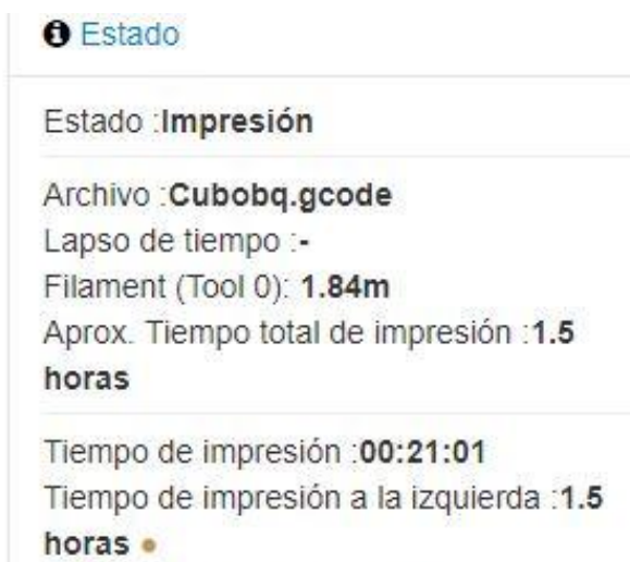
Figura 3.18. Datos del archivo cargado en el sistema Octoprint Fuente: Elaboración propia
