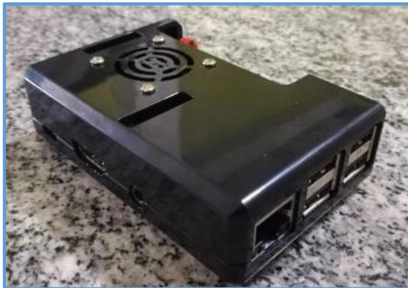
**Figura. 3.3 Case para proteger el dispositivo de señalización digital [Autoría Propia]**
