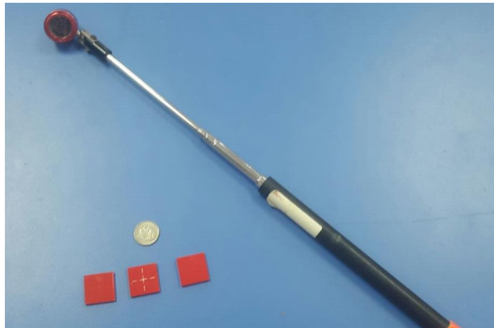
Figura 4.6 Puntos de control de acrílico con miniprisma Fuente: Duque, K., 2018
