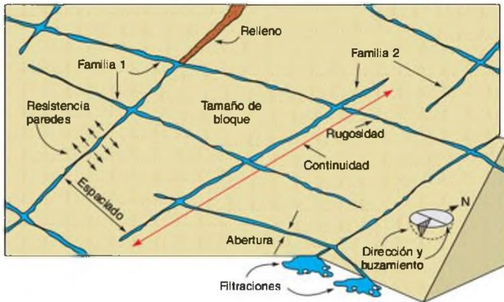
Figura 3.3 Representación esquemática de las propiedades de las discontinuidades
