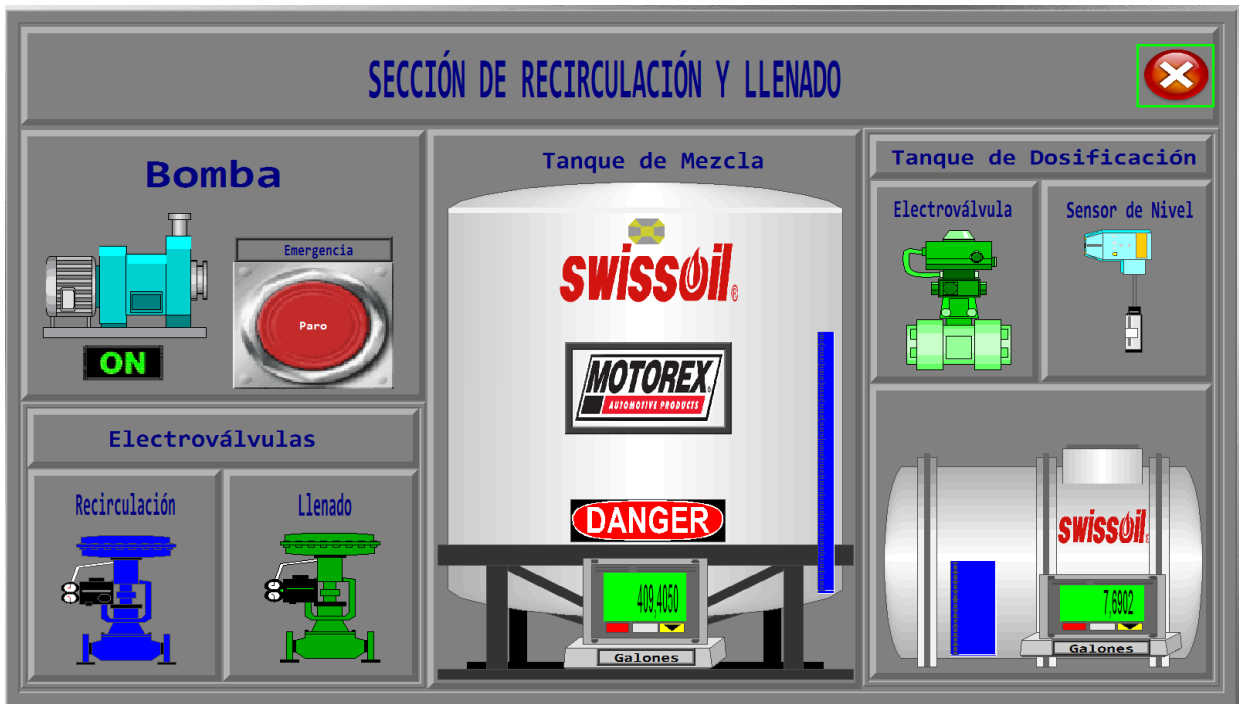
Figura A7-3. Interfaz Gráfica de Control y Supervisión de la Sección de Recirculación de Producto y Llenado del Tanque Dosificador.
