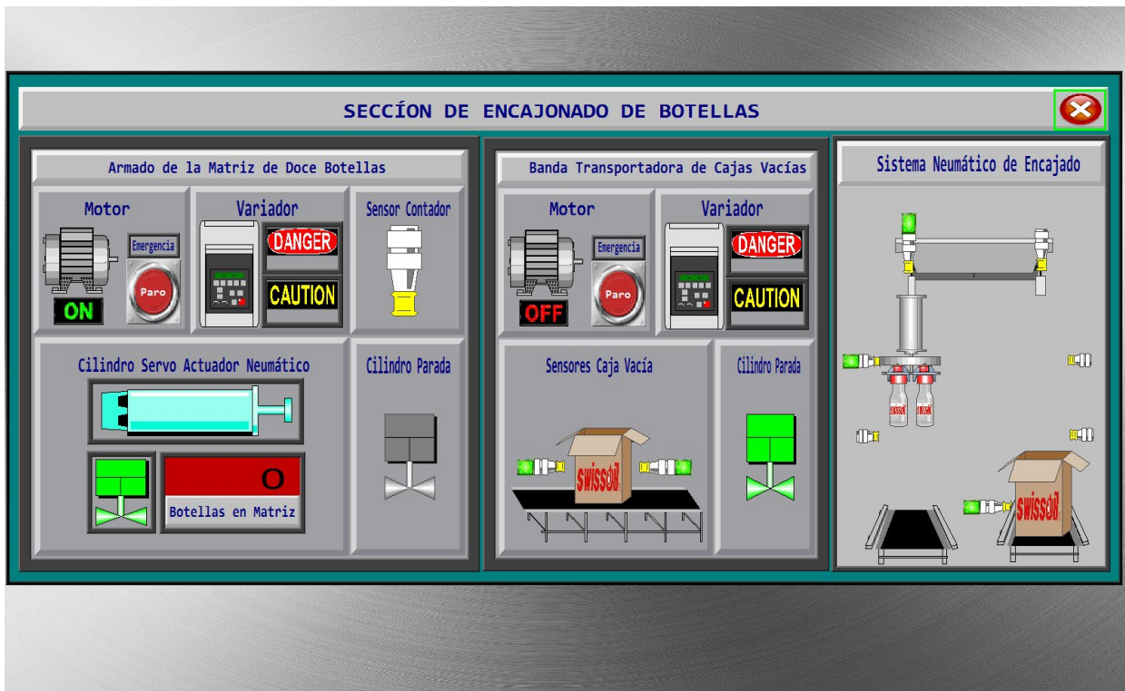
Figura A7-2. Interfaz grafica de Control y Supervisión de la Sección de Encajado de Botellas.
