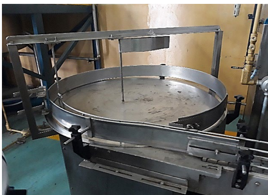
Figura 3-1. Plato Giratorio que Abastece de Botellas Vacías a la Línea de Producción.
