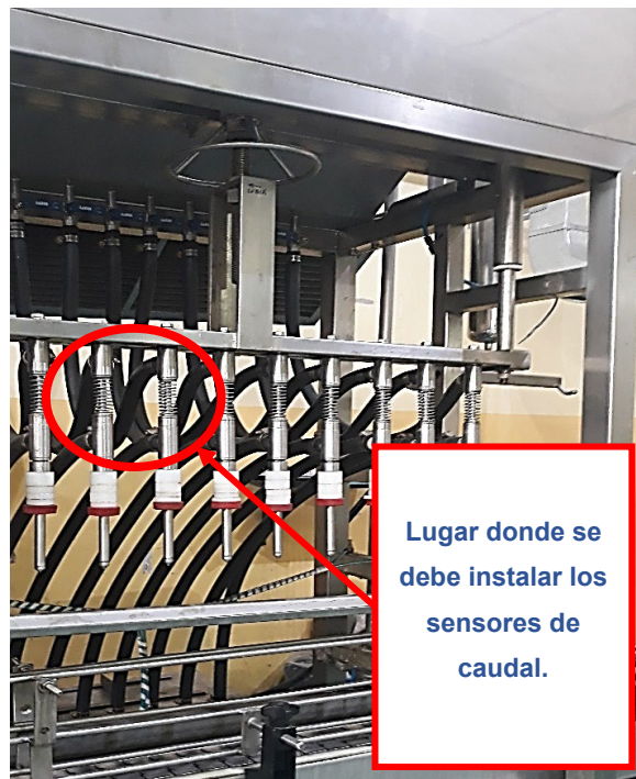
Figura 3-5. Imagen que Muestra Donde Colocar el Sensor SFAW Marca FESTO.
