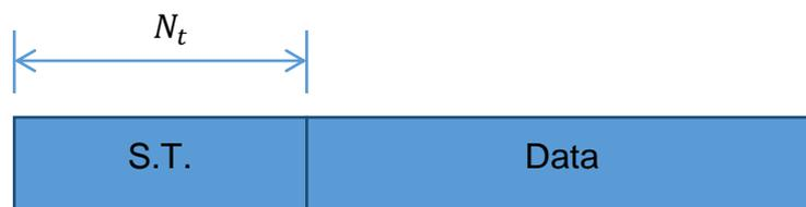
Figura 2.6: Trama de un sistema de una sola portadora.
