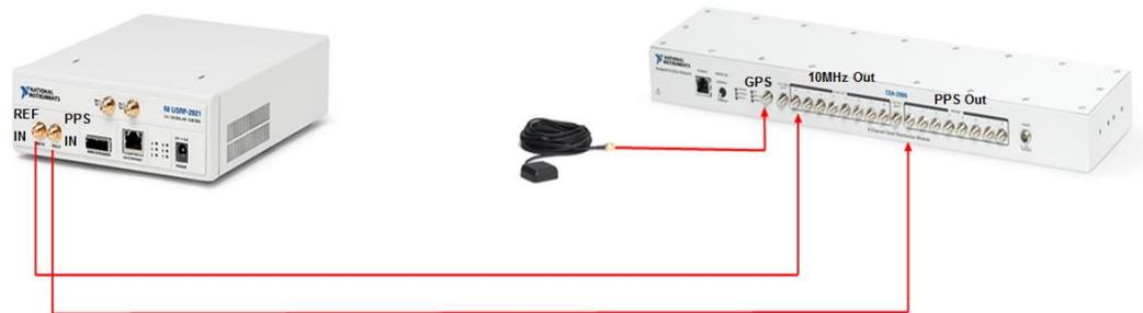
**Figura 2.10: Conexión USRP 2921 – OctoClock.**
