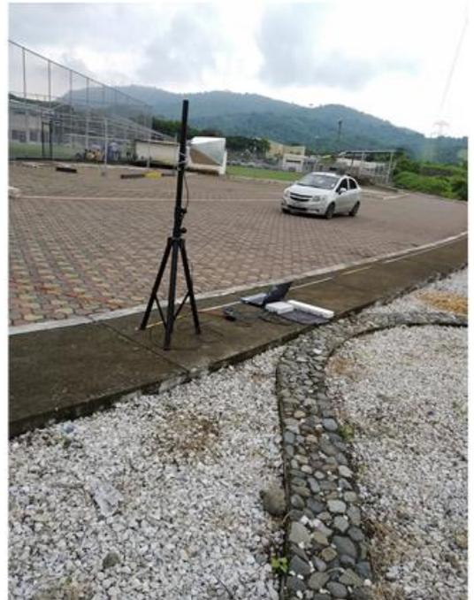
b) Tx: USRP, Antena HORN con trípode, octoclock, ordenador
